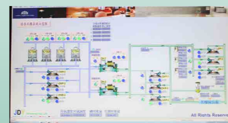
空調冰水系統雲端即時監控
