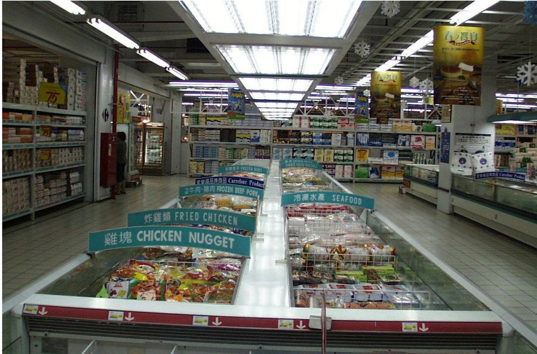
省能方法：採用 40W×4 型高效率電子式柵格式鏡面反射板日光燈具。
