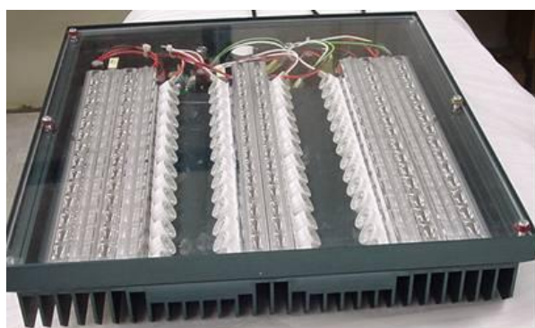
圖 3.3-8 以調整 LED 角度及位置達到照明效果的 LED 路燈
