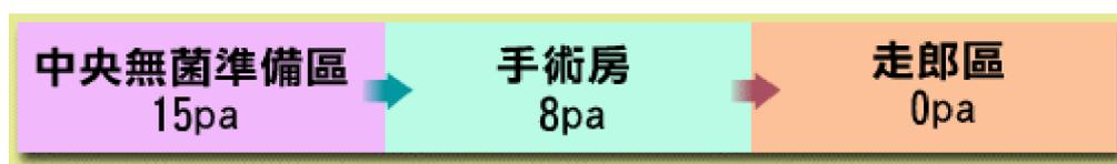
2. 出風口必須加裝高效率過濾器(HEPA)。送風採下吹層流式，氣流必須能將手術台全部覆蓋，流向必須由中央向四周擴散；回風口應有兩個以上，下緣應高於地板10公分。必須有壓差以及溫濕度之監控系統（含濾網差壓、溫溼度等指示）。
