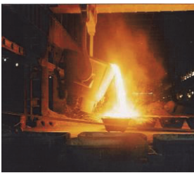
轉爐石熱熔渣(約1200℃)倒置淺盤
