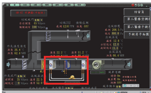
圖 3.空調熱回收系統
