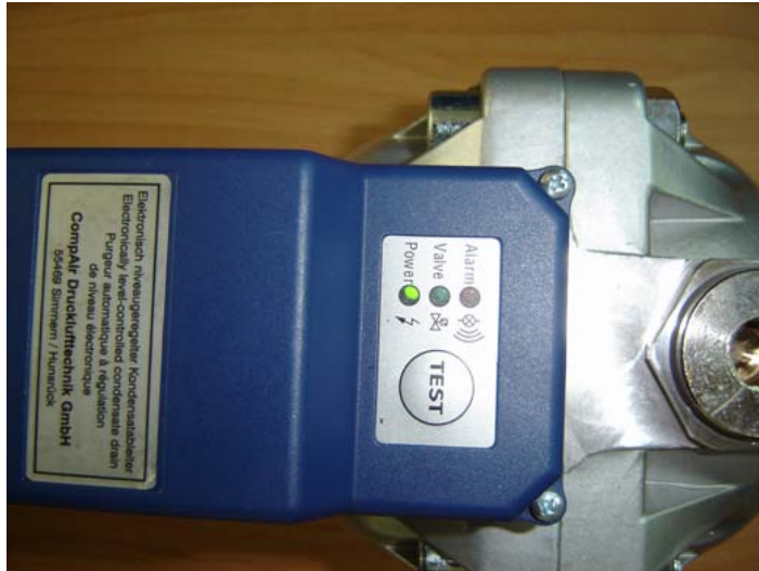
正常時：Power綠燈顯示(Green light Power)
