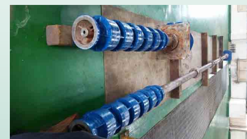
海水攔污沖洗泵改善 - 沖洗泵泵軸
