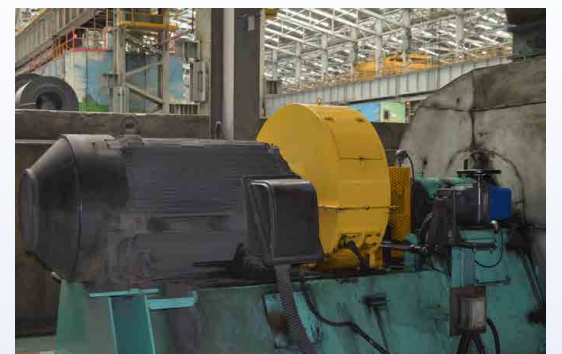
鼓風機節電 - 加裝永磁式調速器，可空載啟動及依運轉需求調速
