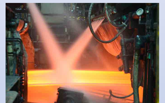
變更除銹水噴嘴流率，進而降低鋼胚出爐溫度
