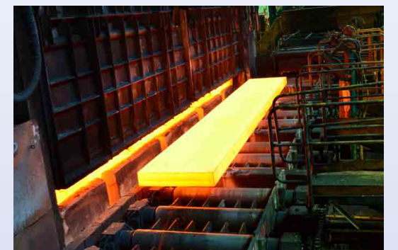
縮短加熱爐門開啟時間，使其與加熱爐爐壓控制系統匹配，抑制爐外空氣吸入爐內，減少加熱爐能耗
