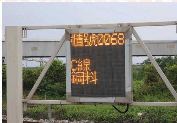
花蓮石料處理課鐵路運輸裝櫃自動化顯示系統
