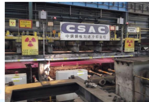
鋼板線上加速冷卻設備
