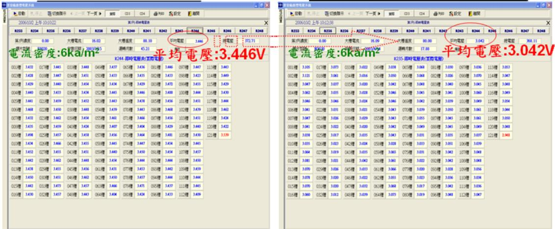
未修改電槽單位用電量2455仟瓦/噸鹼，修改成零極距電解用電量2167仟瓦/噸鹼，節省電解用電量11.7%
