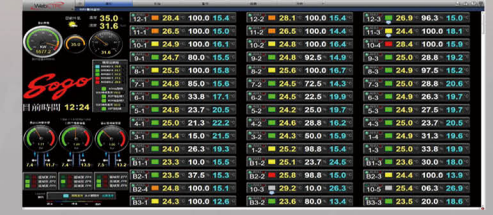
透過賣場及戶外溫度連鎖監控冰水溫度、流量管理、調整達成節電管理
