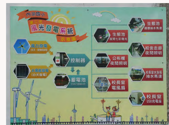
風光發電系統連結示意圖
