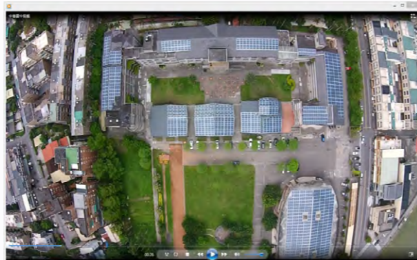
本校屋頂裝設太陽能板，總面積 3300m 2 ，為宜蘭縣裝設太陽能板面積最大的學校。
