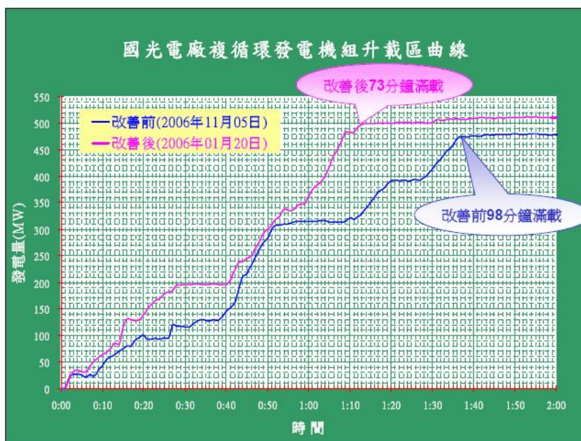
圖一、改善前後發電機組升載曲線比較
