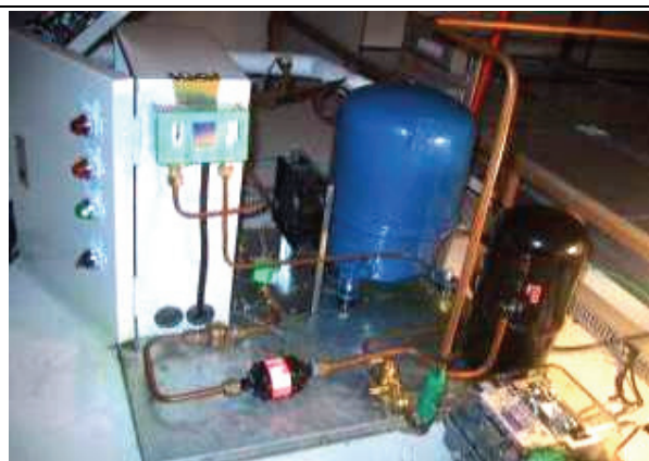
臥式密閉式冷凍展示櫃 3 馬力變頻控制系統(R404A)
