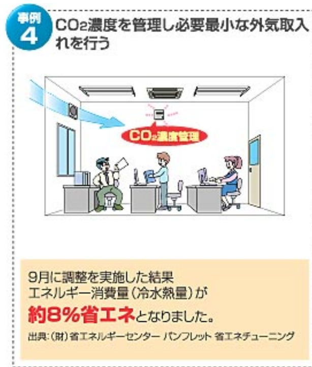
圖 5-10 CO 2 濃度控制外氣最小量引進節能策略示意圖（日本 ECCJ）
